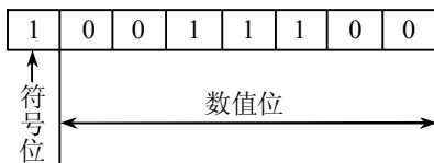
图3-1 在计算机中用一个字节表示一个数示意图
