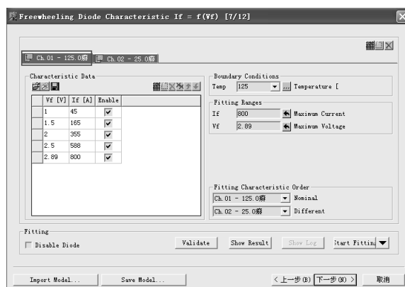
图 3-59 Freewheeling Diode Characteristic I_f=f(V_f) [7/12]对话框（125 度条件下）
