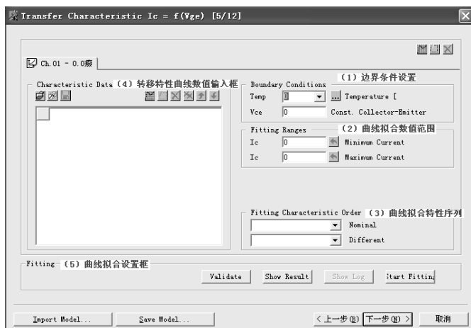
图 3-19 模型创建第五步：IGBT 转移特性曲线输入
