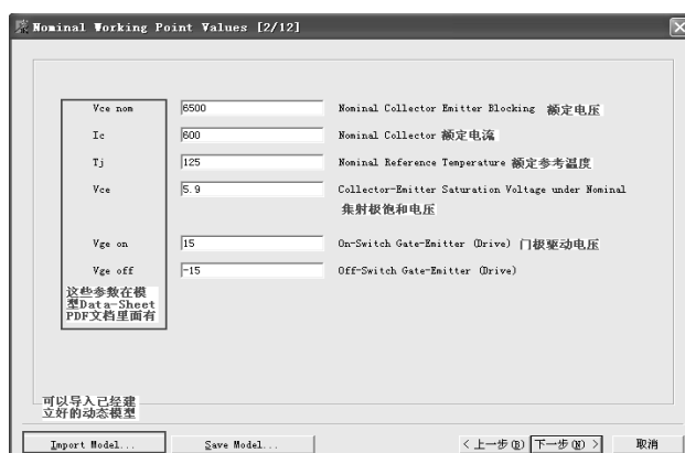
图 3-16 模型创建第二步：额定工作点设置
