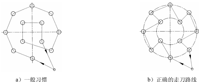
图 2.10.1 走刀路线示意图
