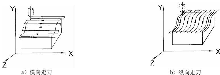
图 2.10.4 曲面铣削走刀路线
