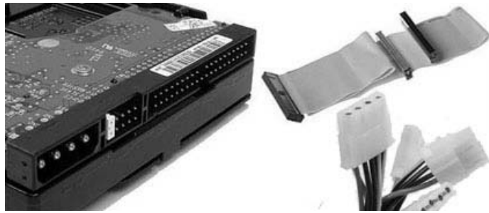
图 1-2-23 IDE 硬盘接口及电源线、数据线
