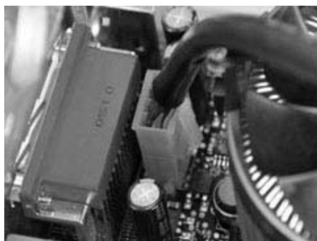
图 1-2-27 连接好的 CPU 插槽及供电接口
