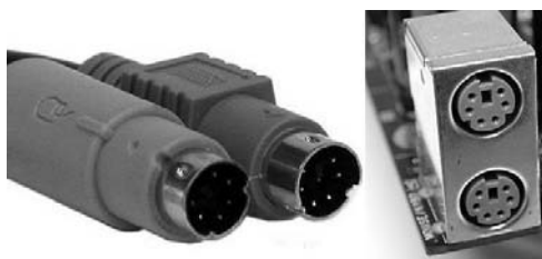
图 1-2-36 鼠标、键盘的 PS/2 插头与主板提供的 PS/2 接口
