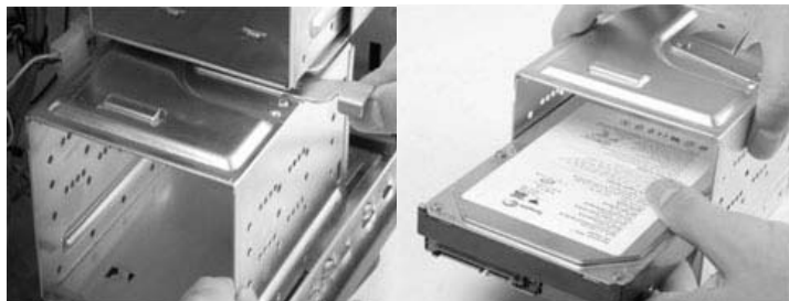
图 1-2-17 取下托架并将硬盘插入托架内
